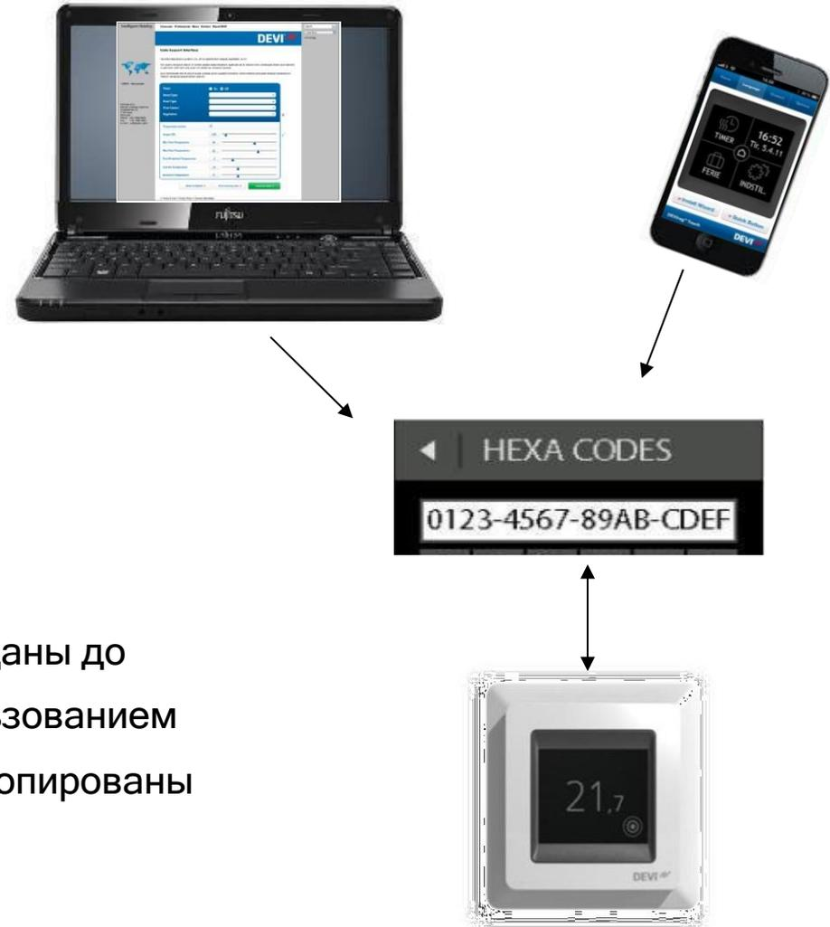
Настройки терморегулятора могут быть заданы до установки и импортированы в него с использованием кода, сгенерированного в Интернете, или скопированы с терморегулятора аналогичной установки
