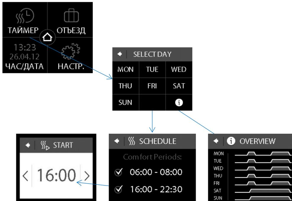
Таймер позволяет автоматически переключаться между экономной и комфортной температурами в соответствии с заранее установленным графиком
